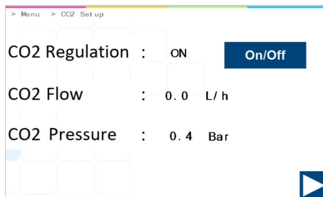
Joonis 13.25. MIRI® TL6 ja MIRI® TL12 mitmekambrilise kehavälise viljastamise inkubaatori CO 2 seadistuse alammenüü vaade
