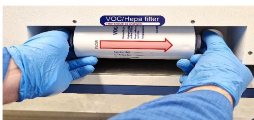
Joonis 12.2. VOC/HEPA-filtri paigaldamise ja eemaldamise protseduur
